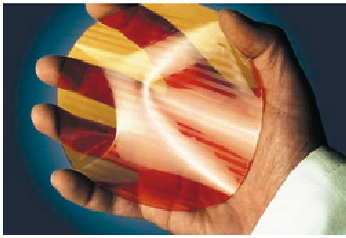
Guides d'onde à base d'Ormocers® hybrides déposés sur substrat flexible Photo : Fraunhofer ISC
