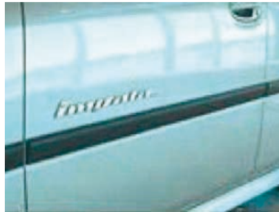
Nanocomposites hybrides à base d'argile pour les marchepieds et les baguettes de protection - Photos : référence 16
